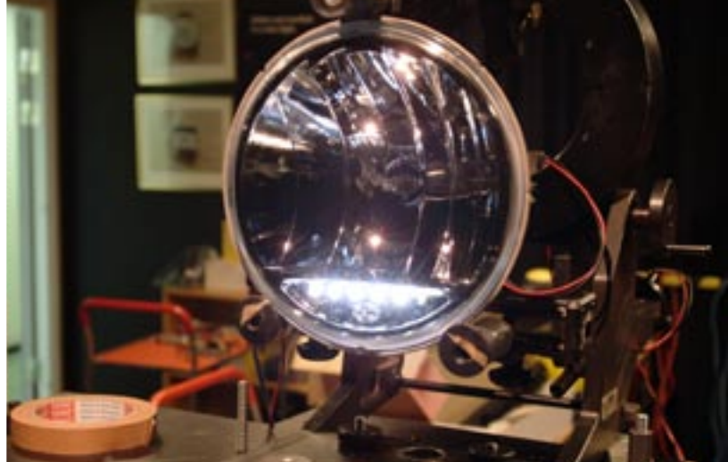
Flera av Hella's extraljus har "upgraderats" med en nedre rad av lysidioder. Lars-Erik Palmér utförde mätningarna.
